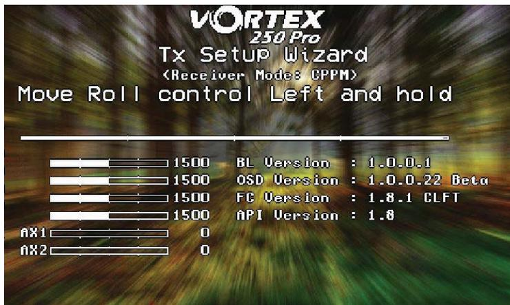
Folgen Sie den Balken können Sie sicherstellen dass der richtige Steuerknüppel bewegt wurde. Jede erkannte Kontrolle wird dabei auf der linken Seite mit Namen aufgeführt.
